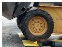
Tunele na deski do bezpiecznego przejazdu kołami bez utraty wody
