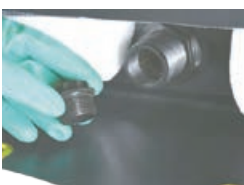
Zawory do łatwego przelania wody
