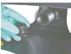
Zawory do łatwego przelania wody
