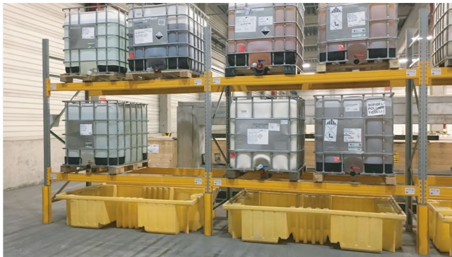
REGAŁY POD ZBIORNIKI IBC POŁĄCZONE Z WANNAMI WYCHWYTOWYMI 102-1-WRA-1028
